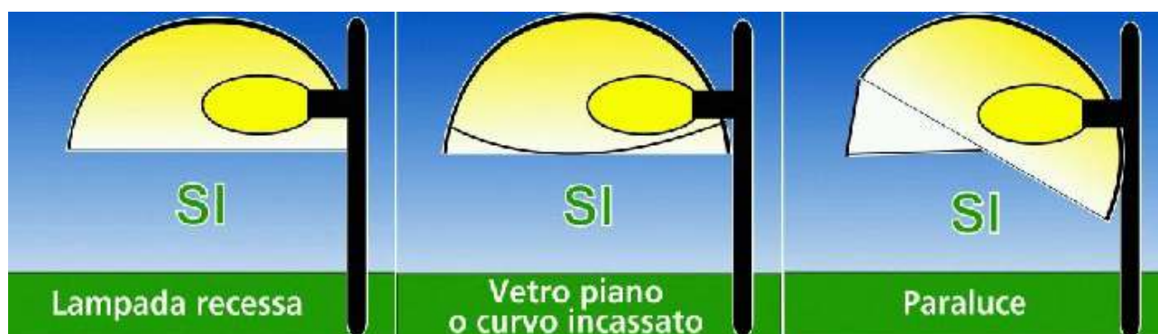
Fig. 2 - Tipologie di apparecchi conformi alla L.R. 19/2003
